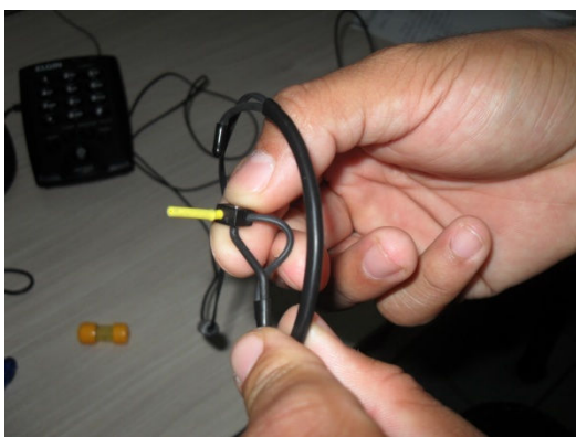
Figura 3 Vista do conjunto suporte e microfone do áudio dosímetro
